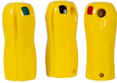
**Marport MFX** 网板传感器使用主副传感器配置，通过110或144kHz横向无线通信链路通信。主传感器询问装在另一网板上的副传感器，通过无线上行宽带通信发送主副传感器的数据到船上。网板水平扩张参数给船长一个有关网板情况的清晰图像，还可包括内外前后角度信息、深度和水温等参数。
